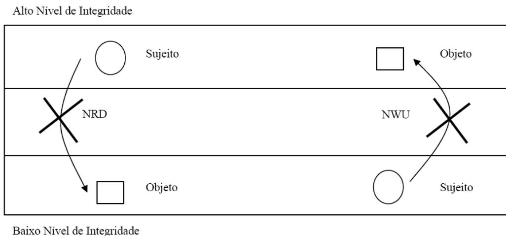
Figura 1.2. Regras do Modelo Obrigatório de Integridade BIBA
