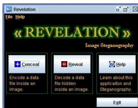
Figura 2.8: Tela inicial do software Revelation utilizado para esteganografia em figuras com formato bitmap de 24 bits.
