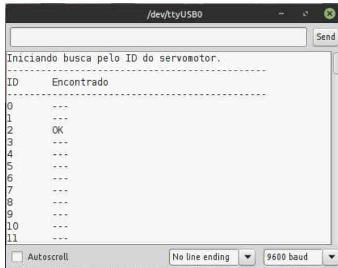
**Figura 2.21.** Saída do programa que mostra o ID de um servomotor na janela de monitoramento da porta serial
