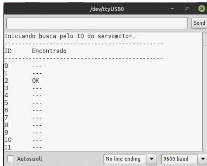
Figura 2.21. Saída do programa que mostra o ID de um servomotor na janela de monitoramento da porta serial
