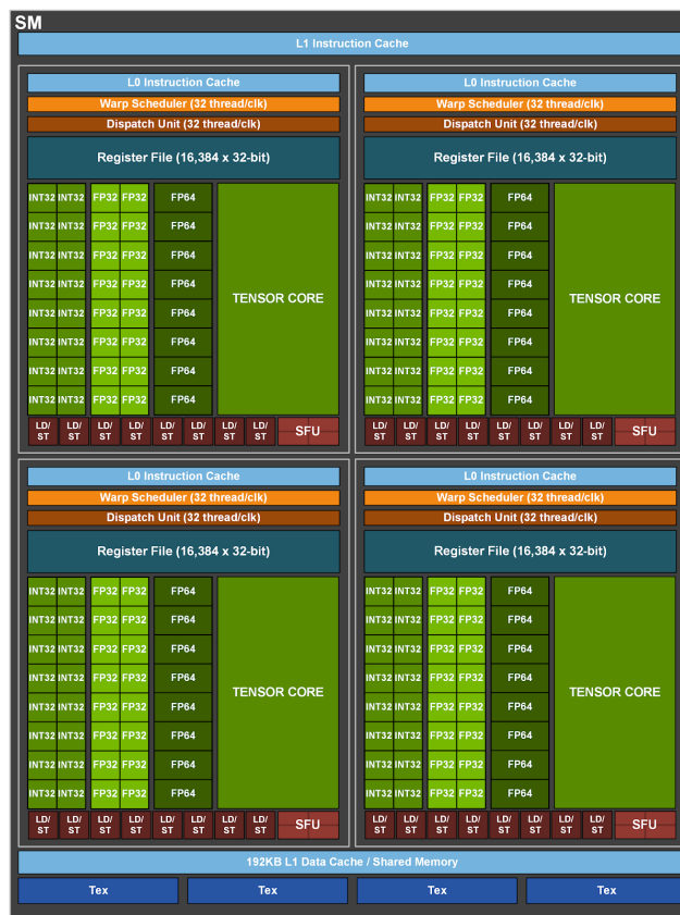
Figura 4.2. SM da arquitetura Ampere da NVIDIA - [Zone 2019]
