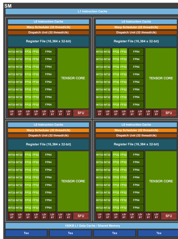
Figura 4.2. SM da arquitetura Ampere da NVIDIA - [Zone 2019]
