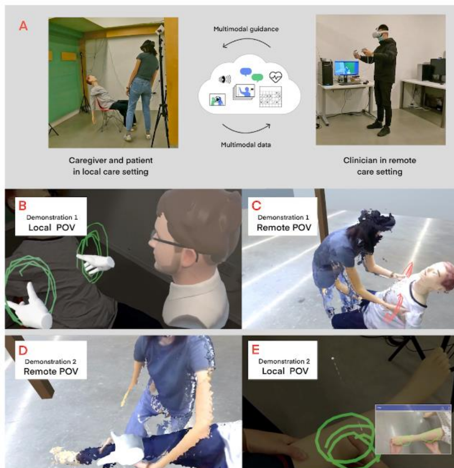
Figura 5.7. Protótipo de sistema de teleinterconsulta utilizando realidade virtual e realidade aumentada. Fonte: [Dinh et al., 2023].
