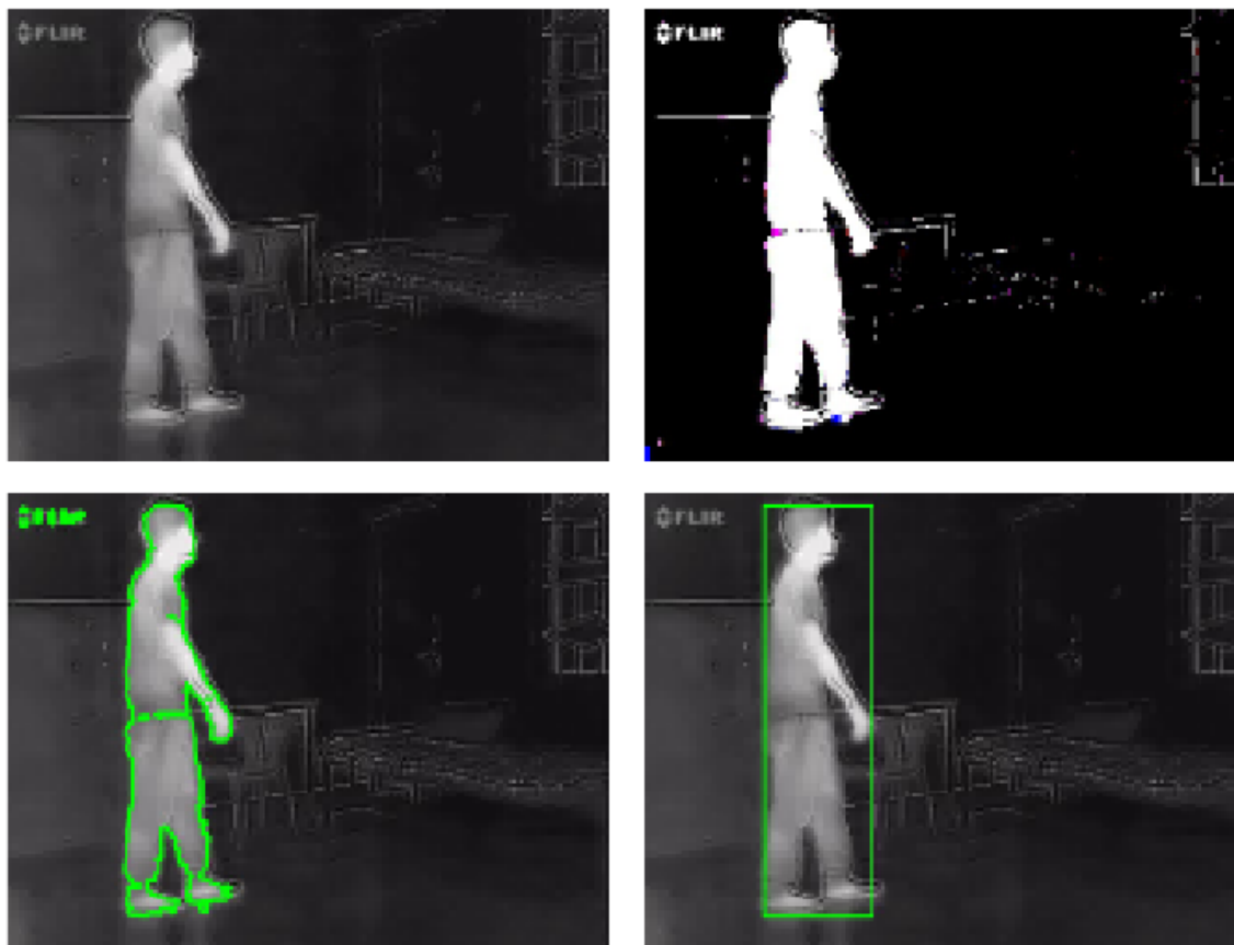
Figura 5.11. Tratamento das imagens para detecção de quedas com câmeras termais usando o 3DCAE. Fonte: [Mehta et al., 2021].
