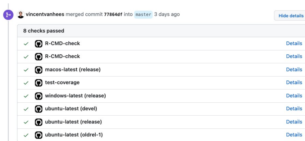
Figura 3.12. Tarefas automatizadas executadas após a incorporação de um pull request no repositório do software de pesquisa .
