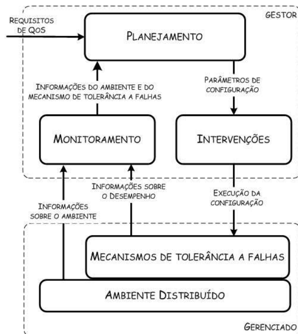
Figura 2.5. Laço de gestão implementado pelos mecanismos autônômicos de tolerância a falhas [de Sá 2011].
