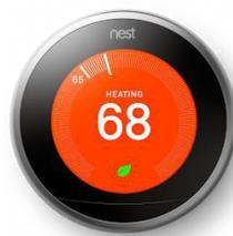
Figura 6.2. Termostato Inteligente conectado a Internet
