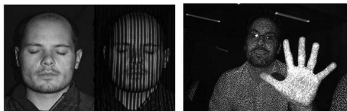
Figura 3.3. Luz estruturada (a) usada no mapeamento da face [18] e (b) Nuvem de pontos de luz emitidos a partir do sensor IR do Kinect.
