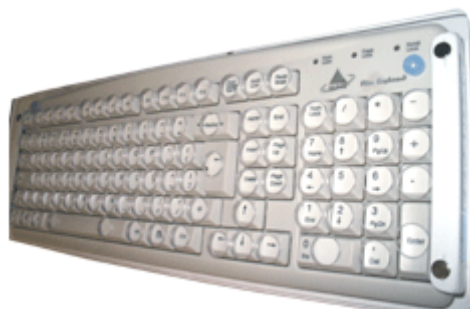
Figura 1.4: Teclado colmeia, com restritores de acrílico sobre as teclas para evitar o pressionamento simultâneo indesejado Fonte: http://www.civiam.com.br
