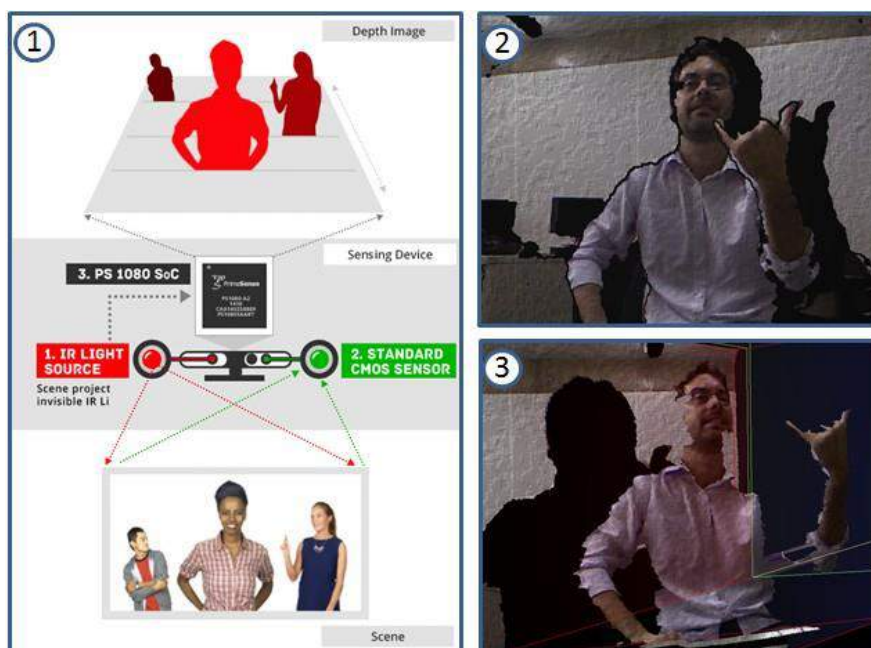
Figura 3.4. (1) Exemplo do diagrama do sensor da PrimeSense [PrimeSense 2011]. (2) e (3) são imagens RGB com seus pixels associados à profundidade.
