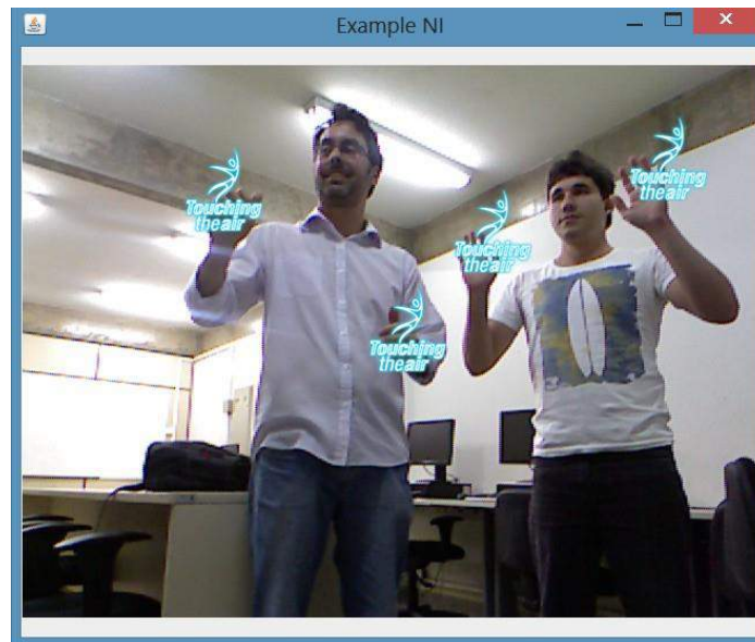
Figura 3.45. Tela de uma aplicação que reconhece um gesto, e inicia o rastreamento da mão exibindo uma imagem na posição da mão rastreada.
