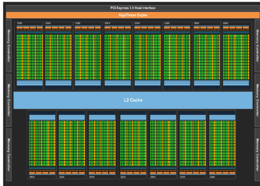
Figura 3.1: Arquitetura NVIDIA Kepler
