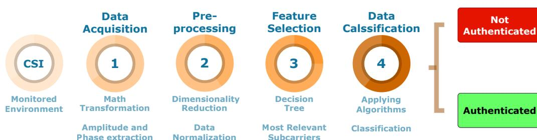
Figura 4.9. Fluxo para aquisição de dados, pré-processamento e avaliação.
