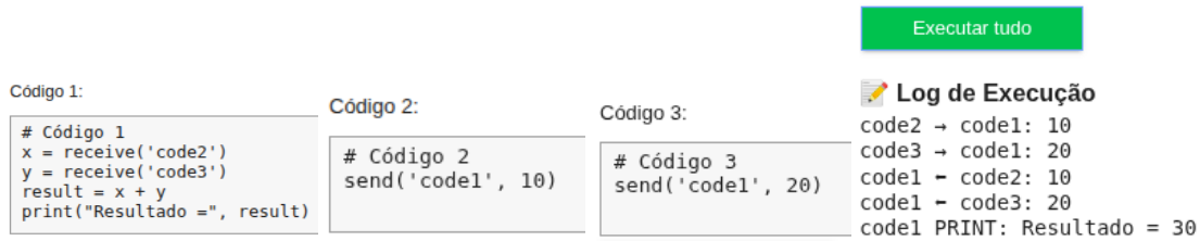
Figura 1.17. Simulador com três multiprocessadores por troca de mensagens e suas janelas de código, usando a linguagem Python. Clique aqui.
