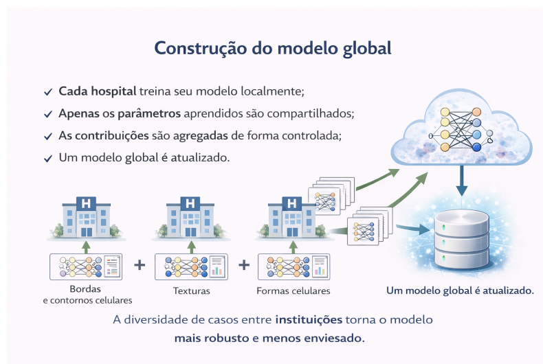
Figura 4.7. Processo de agregação no aprendizado federado. Os parâmetros dos modelos locais são combinados para formar um modelo global sem acesso aos dados originais.
