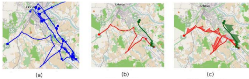
Figura 1.6. Processo para extração dos perfis individuais de mobilidade: (a) identificação das trajetórias do veículo; (b) clusterização de trajetórias; (c) sumarização e seleção de perfil de mobilidade mais representativo [Celes et al. 2013].
