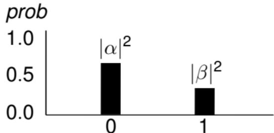
Figura: Histograma da distribuição de probabilidades da saída quando o estado do qubit  $|\psi\rangle$  antes da medida é  $\alpha|0\rangle + \beta|1\rangle$
