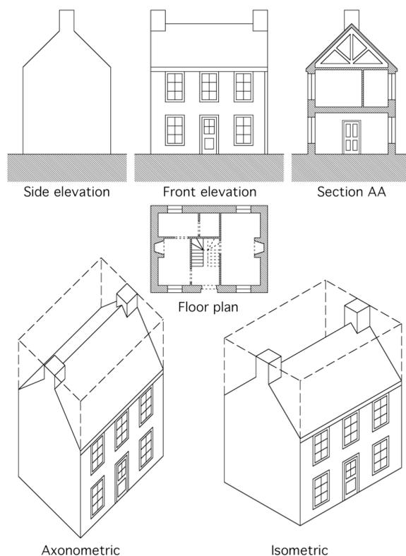
**Figura 1.2.** Visões comumente utilizadas no desenho arquitetônico de edificações. Fonte: Wikimedia Commons (Licença: CC BY-SA 3.0)
