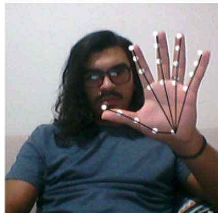
Figura 6.24. Mapeamento da mão em tempo real usando o HandPose .
