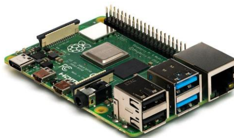
Figura 5: Raspberry Pi 4 - Modelo B
