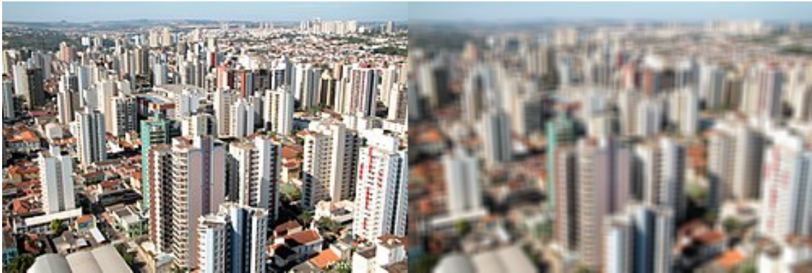
Figura 1.5. Imagem original à esquerda. À direita, imagem com aplicação do filtro de média com janela de tamanho 5.
