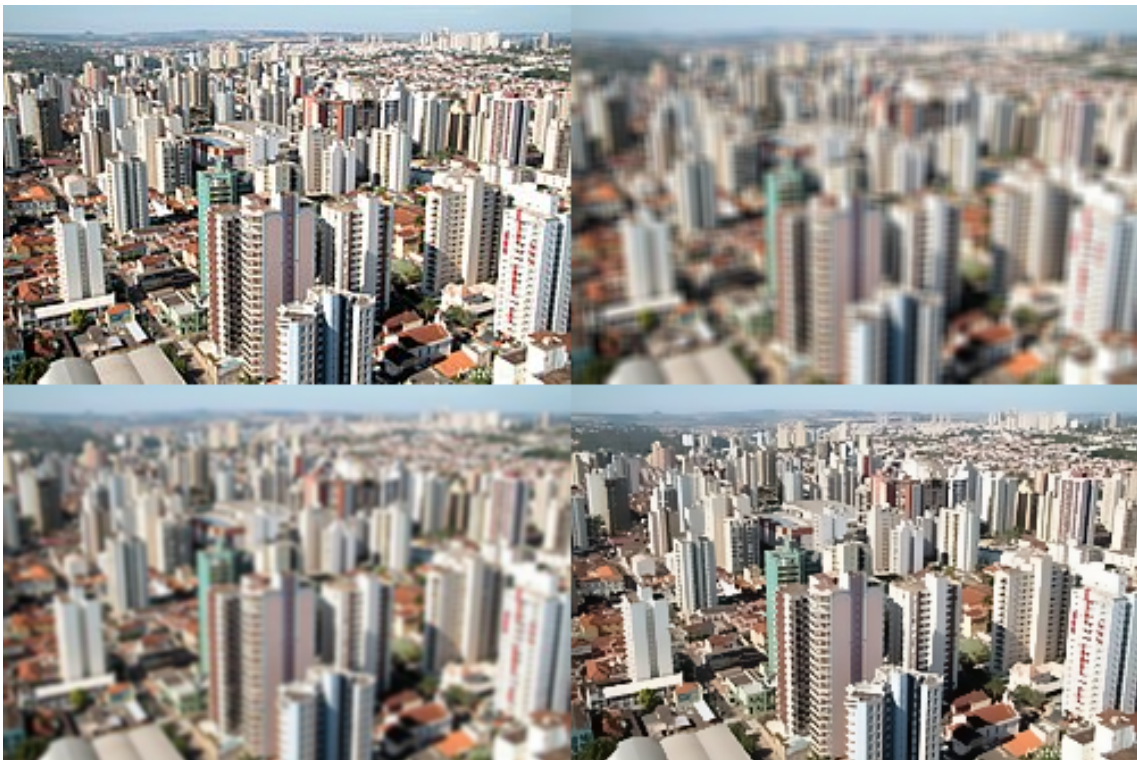
Figura 1.6. Comparativo de métodos de borragem. A primeira imagem é a original. A segunda, filtrada pela média. A terceira, utilizando um filtro gaussiano. A última, utilizando filtro bilateral.
