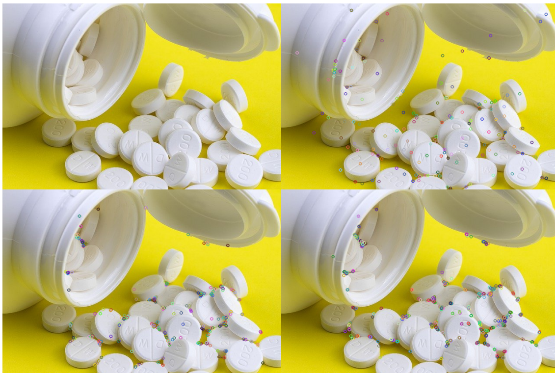
Figura 1.10. Vários métodos para detecção de keypoints . No superior, à esquerda temos a imagem original e à direita, a detecção usando SIFT. No inferior, à esquerda o resultado do BRISK e à direita, o ORB.
