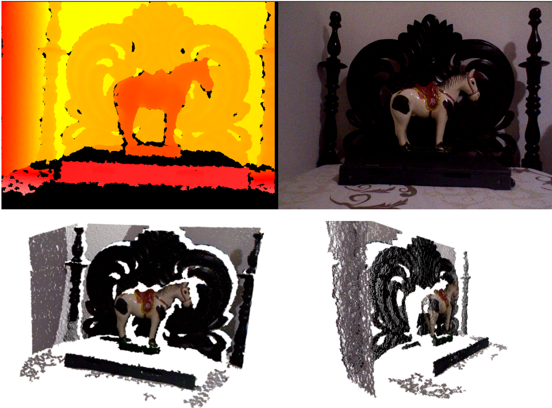
Figura 1.4. Imagens geradas pelo Kinect . Novamente, vemos o mapa de profundidade a esquerda e a captura da câmera a direita. Na segunda linha, temos dois pontos de vista diferentes da nuvem de pontos gerada com base nas duas imagens superiores.
