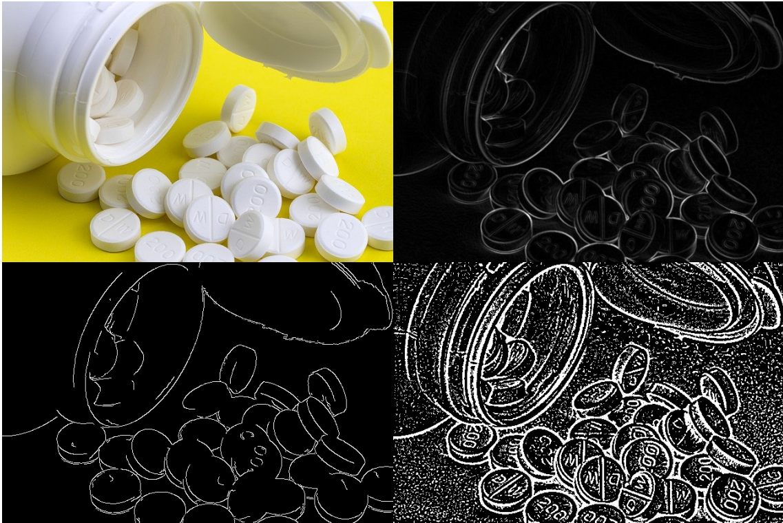
Figura 1.9. Vários métodos para detecção de bordas. No superior, temos a imagem original e o filtro de Sobel . No inferior, à esquerda temos o filtro de Canny e à direita a Diferença de Gaussianas.
