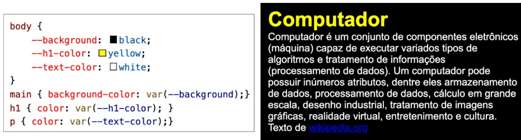
Figura 1.10. Alteração das cores do tema de uma página web com o uso de variáveis em CSS. Código CSS (quadro esquerdo). Visualização da página no navegador (quadro direito).
