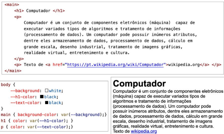
Figura 1.9. Definição das cores do tema de uma página web com o uso de variáveis em CSS. Código HTML (quando superior). Código CSS (quadro inferior esquerdo). Visualização da página no navegador (quadro inferior direito).
