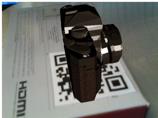
Figura 6.3. Tela de uma aplicação que utiliza uma imagem com QR Code como janela para inserir um objeto virtual na imagem, em tempo de execução. Fonte: (KAN; TENG; CHOU, 2009)
