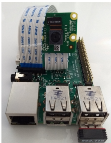
Figura 4.2. Câmera conectada ao Raspberry pela interface CSI.
