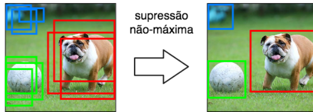
Figura 3.30. (cima) Visualização da saída do YOLO. (baixo) Remoção das BBs sobrepostas com o filtro de supressão não-máxima.
