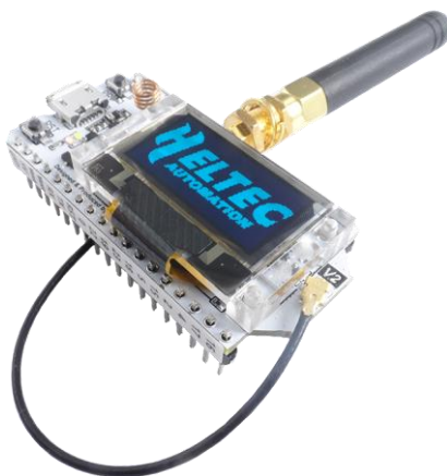
Figura 1.4: Heltec WiFi LoRa 32 V2 [12]
