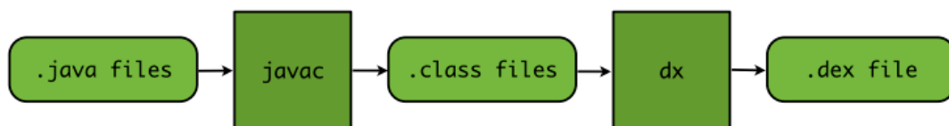
Figura 2: Transformação de código fonte Java em Dex. Fonte: [Strazzere 2012].
