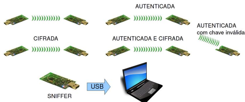
Figura 4.6. Configuração da *testbed*.
